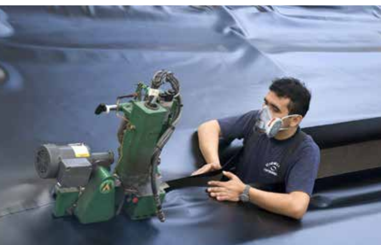
Fabricación de paneles.
