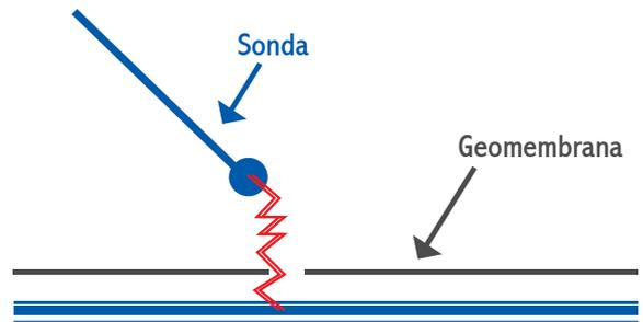
La sonda del dispositivo se desliza sobre la superficie y donde está la falla, ya sea una rotura, punzonamiento, rajaduras u otras, se produce una chispa luminosa y audible por el operador, al producirse la diferencia de potencial eléctrico. La chispa puede alcanzar hasta a la distancia de 25 mm. El tamaño de la chispa dependerá principalmente de la conductividad del suelo.
