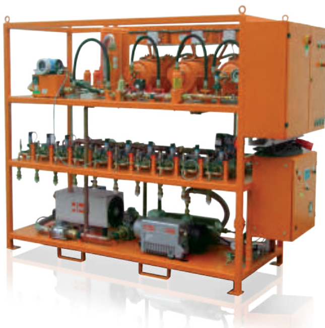
Potente unidad independiente con 10 conexiones en paralelo para evacuar aire, rellenar el compartimento de gas y recuperar gas SF 6 .
