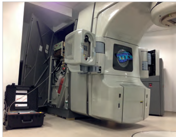
Unidad de mantenimiento B160R92 adaptada a los requisitos de compartimientos pequeños. La foto muestra el aparato durante trabajos de servicio en una unidad de radiación.
