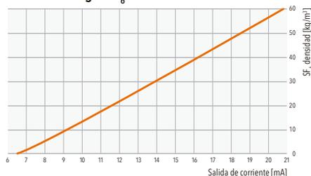
La salida del bucle de corriente tiene una resolución de 6,5 ... 20 mA. Trafag proporciona fórmulas de conversión para la densidad del gas y la presión normalizada del gas a 20°C para el SF<sub>6</sub> y los gases aislantes alternativos.
